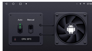
Rys 40 Włączany po przekroczeniu ustawionej temperatury
