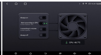
Rys 39 Włączony po przekroczeniu nastawionej temperatury procesora
